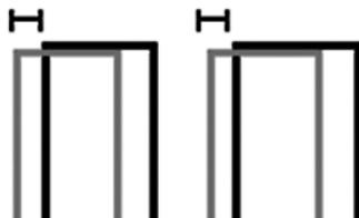
Каждый сигнал, излучаемый пультом, на самом деле состоит из очереди коротких и длинных импульсов. Для одной и той же кнопки в целом значение каждого из них одинаково. Но, поскольку пульт неидеален, то каждый раз длительности могут немного сдвигаться от среднего значения.
